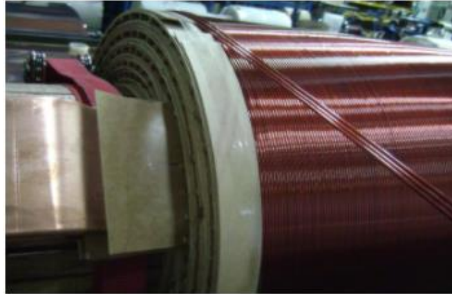
Ilustración 5 Enrollamiento de alambre de cobre para formar bobina de trafo inmerso en liquido aislante
