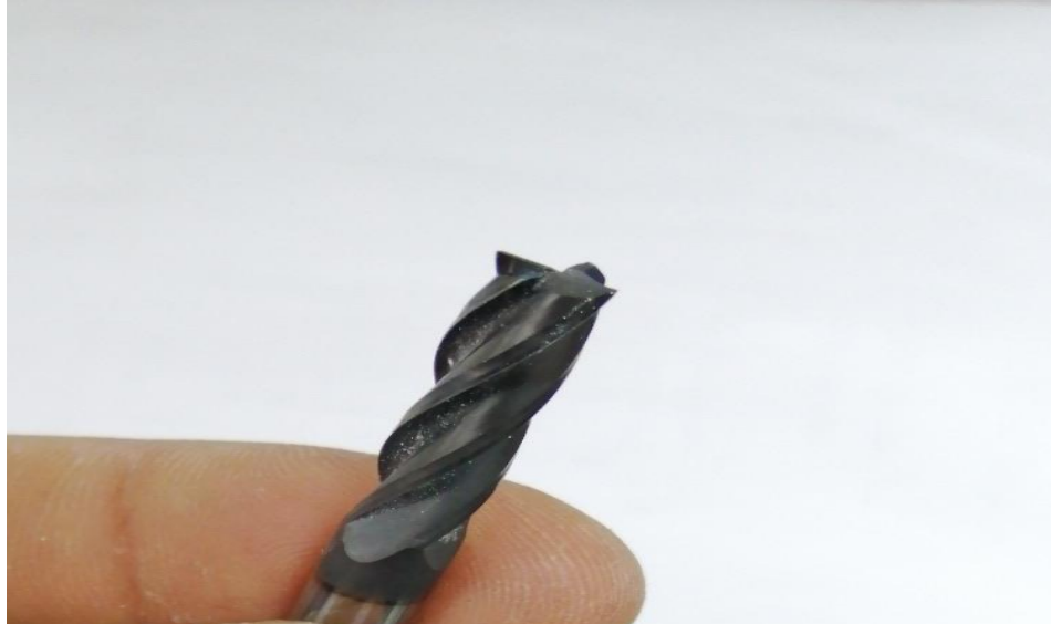
Nota: fresa de corte de 6mm, helicoidal de 4 filos fuente: autor
