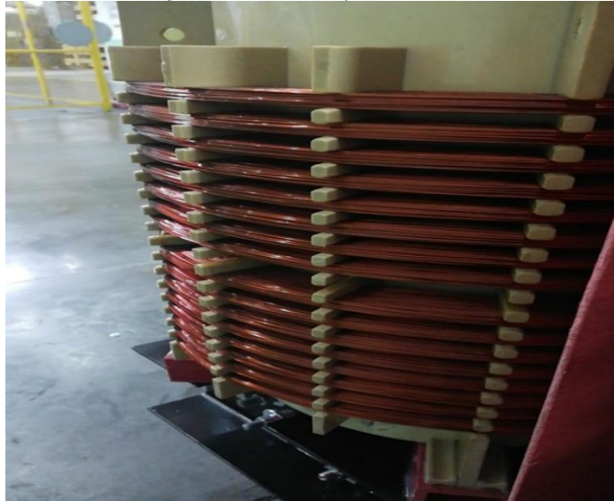
Ilustración 1 bobina de transformador seco tipo abierto clase H
