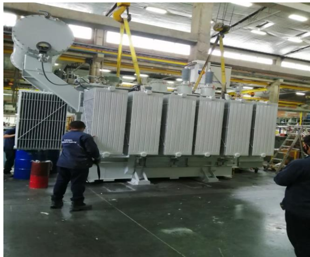
Ilustración 7 Trafo inmerso en aceite 25MVA
