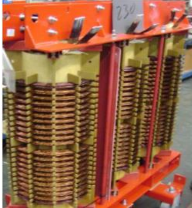
Ilustración 4 Ensamble de bobinas y núcleo ferromagnético
