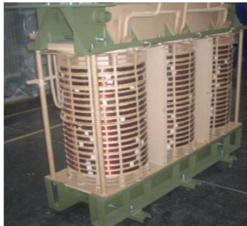
Ilustración 6 Bobinas de trafo trifásico puestas a punto
