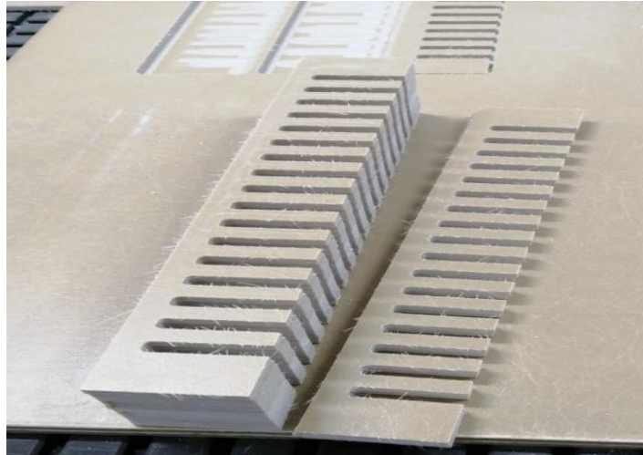
Nota: acabado de peines en proceso de pruebas fuente: autor
