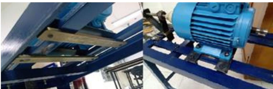
**Figura 19.** Sujetador inferior y ajuste de motor. Elaboración propia
