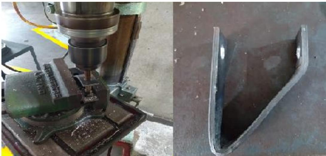
**Figura 12.** Elaboración de apoyo del eje. Elaboración propia
