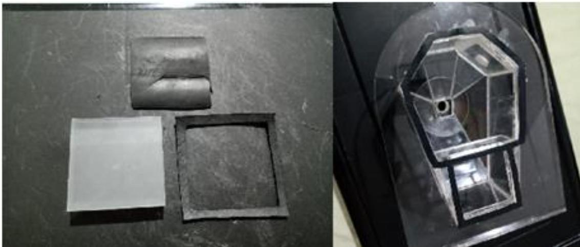
**Figura 8.** Empaques de impermeabilización. Elaboración propia
