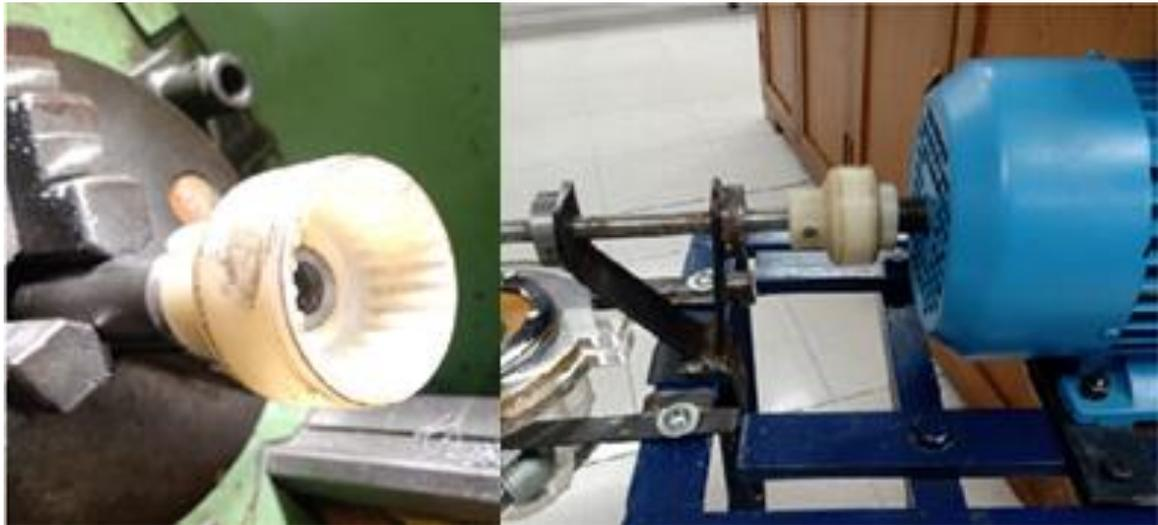
**Figura 18.** Acople de motor. Elaboración propia
