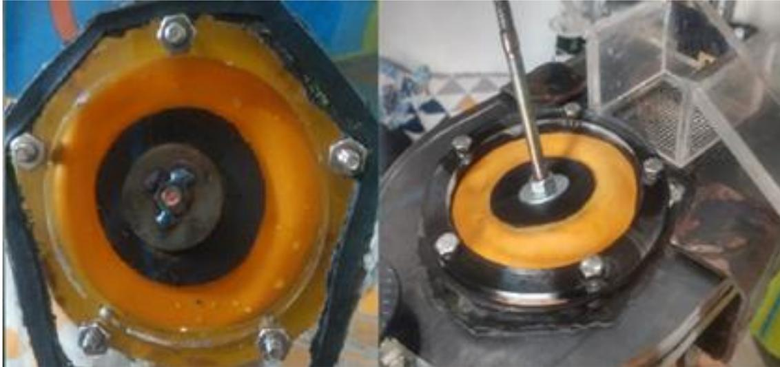
**Figura 16.** Sujeción del vástago. Elaboración propia
