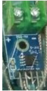
Figura 8. Modulo para sensor MAX6675. Fuente: Autores.
