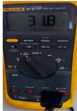
Figura 49. Medición con termocupla del multímetro marca FLUKE 289. Fuente: Autores.
