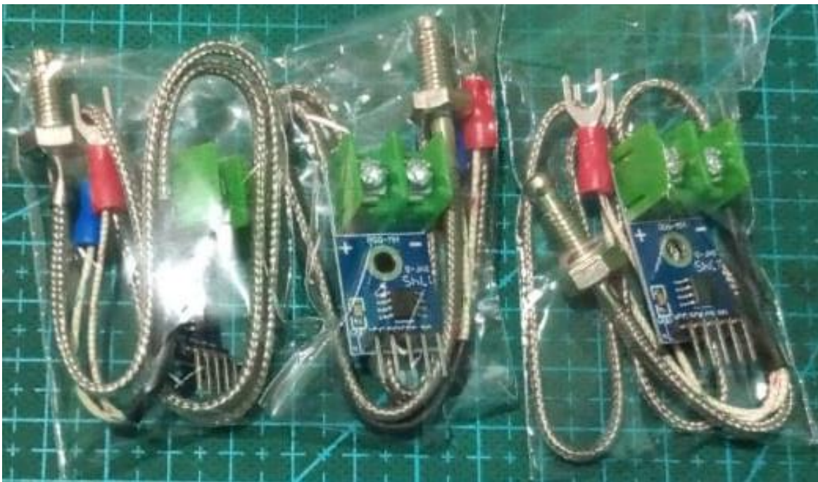
Figura 5. Termocuplas tipo k más modulo MAX6675. Fuente: Autores.
