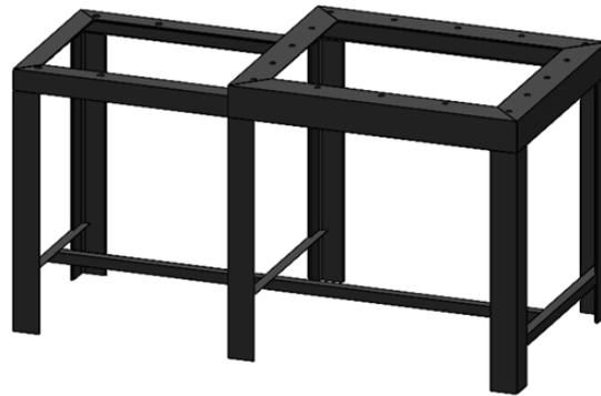
Figura 16. Estructura de la máquina.
