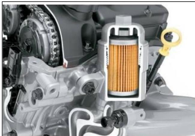
Figura 5. Filtro de cartucho intercambiable
