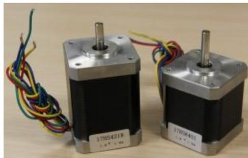
**Figura 4.11: Motores NEMA 17**
