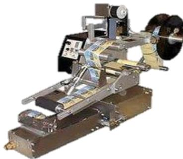
**Figura 2.9 Etiquetadora Semiautomática.**
