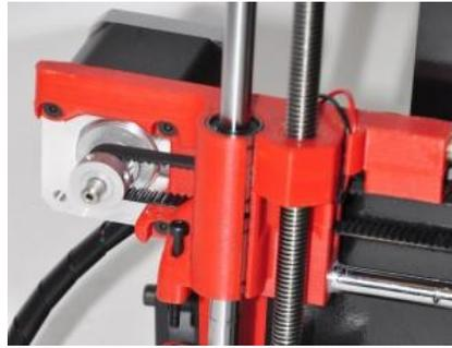
**Figura 4.13: Motor de 40 N·cm del eje X de la DIMA LT**
