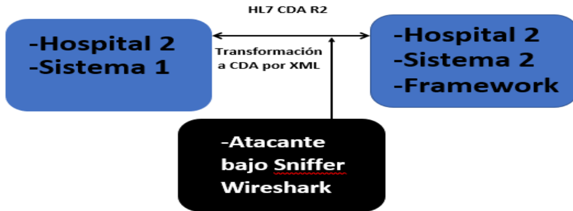
Figura 4-3.: Modelo de red HL7 CDA R2 Punto a Punto, Fuente: Elaboración Propia
