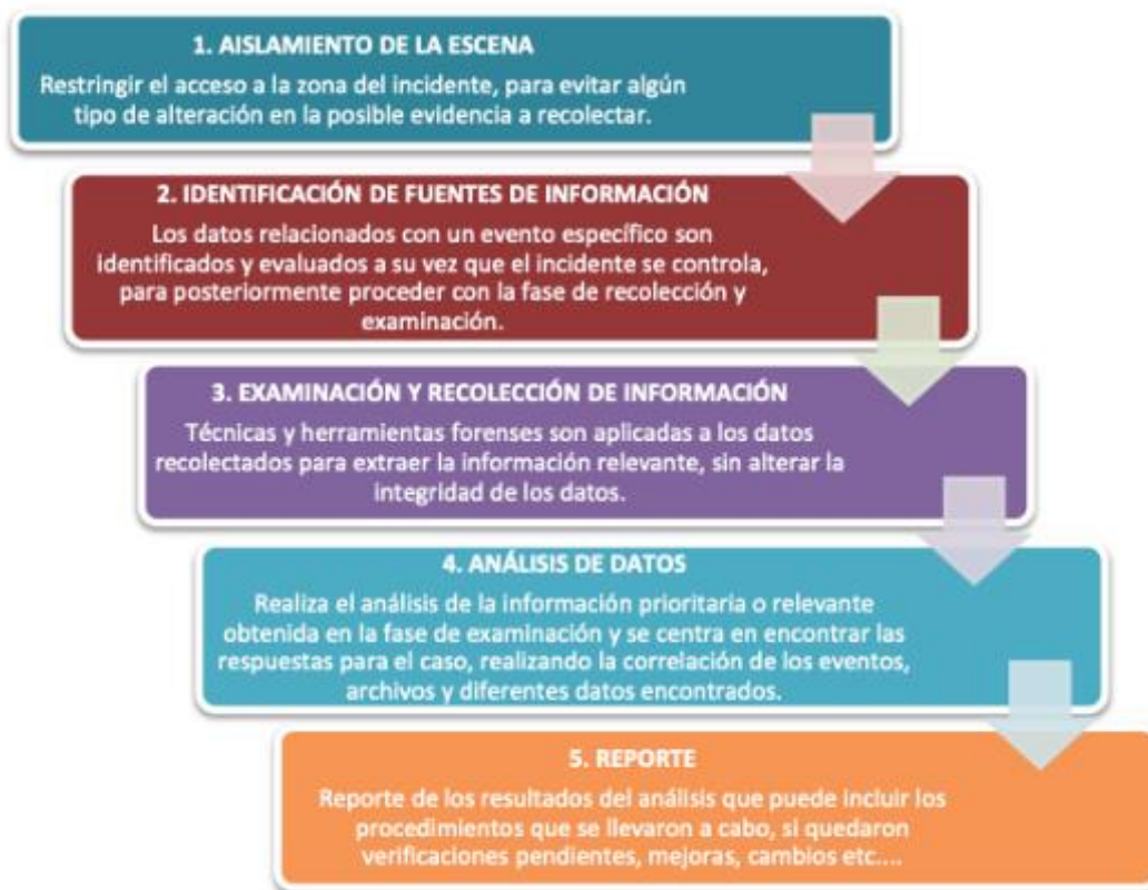
Figura 2: Diagrama del proceso de evidencia digital. Fuente: Guía No. 21, Seguridad y privacidad de la información MinTIC [17]
