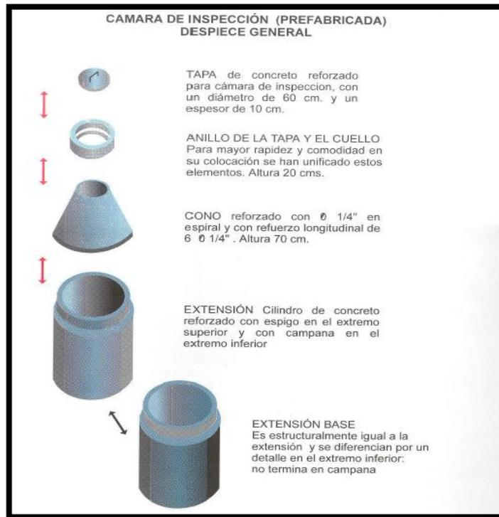
En la gráfica se puede apreciar la cámara de inspección con sus distintas partes: cañuela, fondo o mesa, cilindro, cono, cuello, tapa y peldaños con las medidas apropiadas para diámetros entre 8" y 30".
