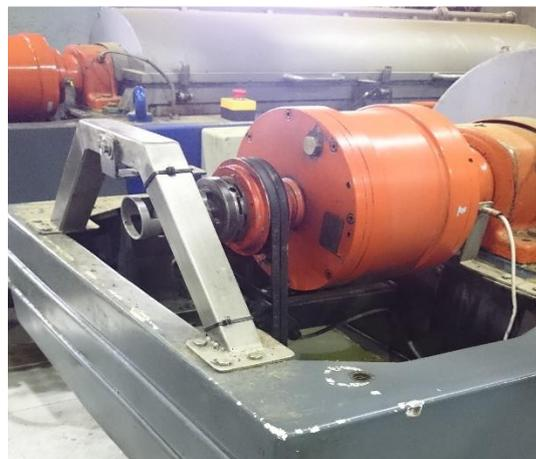
**Figura 15. Base para sensores de velocidad.**
