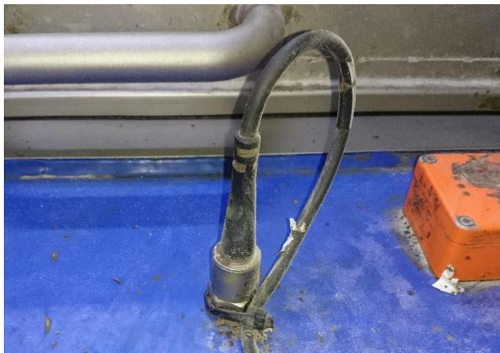
Figura 11. Sensor de vibración
