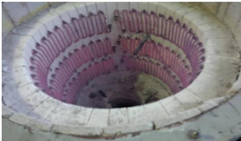
**Figura 2-4:** Sistema de resistencias en hornos de cementación (temple) (Forjas Bolivar SAS, 2019)
