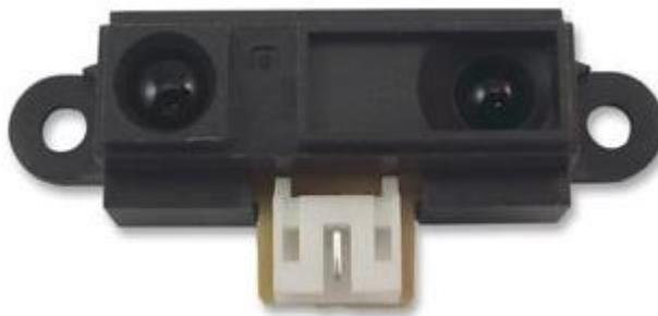
*Ilustración 10: Sensor de distancia Infrarrojo*
