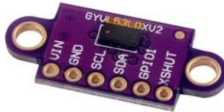
*Ilustración 9: Sensor de distancia Laser*
