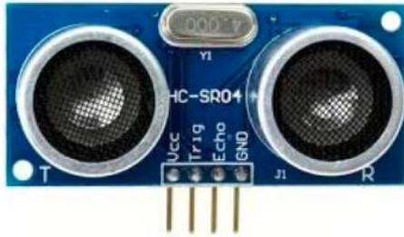
*Ilustración 8: Sensor de distancia Ultrasónico*
