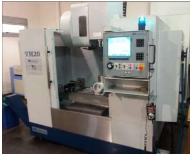
Figura 17. Centro de Mecanizado
