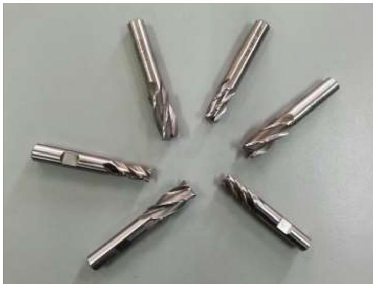
Figura 19. Herramientas de 8, 9.52, y 12 mm de acero rápido
