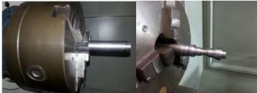
Figura 3. Arranque de viruta a partir del material en bruto.
