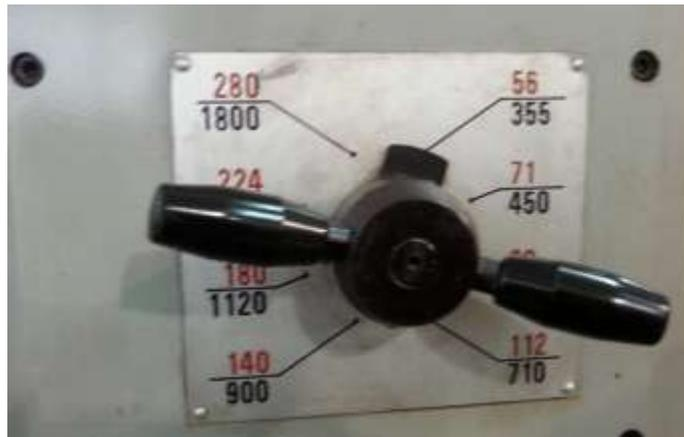
Figura 7: Velocidades de giro Fresadora Convencional.
