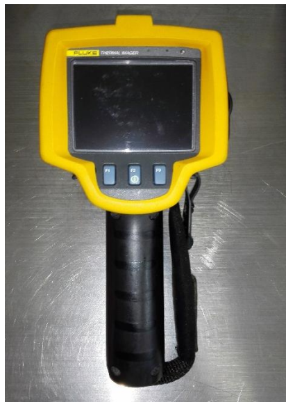
Figura 18: Cámara termográfica FLUKE Ti25. Fuente: Autor
