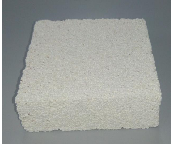
Figura 39: Bases de las resistencias en material refractario. Fuente: Autor
