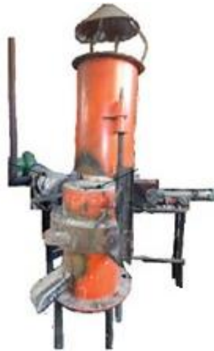
Figura 5. Modelo de horno Cubilote. Fuente: (López & Trejos, 2013)
