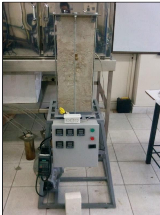
Figura 17. Prototipo del recuperador de calor completo. Fuente: (Imbol Rúa, 2015).
