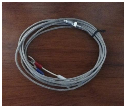
Figura 31. Termocupla tipo K, 95°C a 1250°C.
