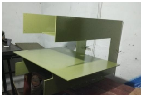
Figura 25. Aplicación Wash estructura.
