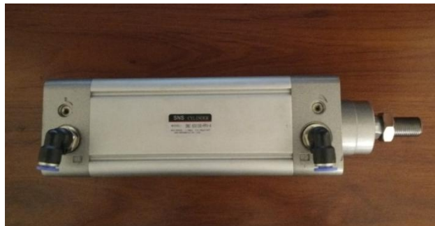
Figura 35. Cilindro neumático de doble efecto 0.9 Mpa.
