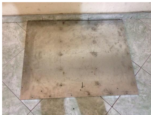
Figura 27. Placa de aluminio longitud 70cm x 90 cm, espesor 16 mm.
